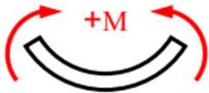
Изгибающий момент  $M$  в сечении положителен, если он вызывает сжатие в верхней части бруса, а растянутая область изгибаемого элемента – в нижней.
